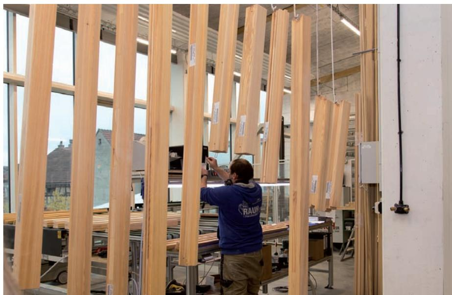
*Transportwagen haben ausgedient. Nach der Sichtung der Kanteln kann der Mitarbeiter diese direkt in die Traversen der Beschichtungsanlage einhängen.*
