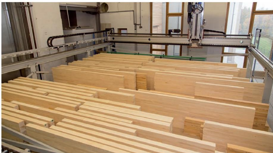
*Ein Puffer, in dem bis zu 1.000 auf dem Vierseiter ausgehobelte Kanteln zwischengelagert werden, versorgt die Working Process.*
