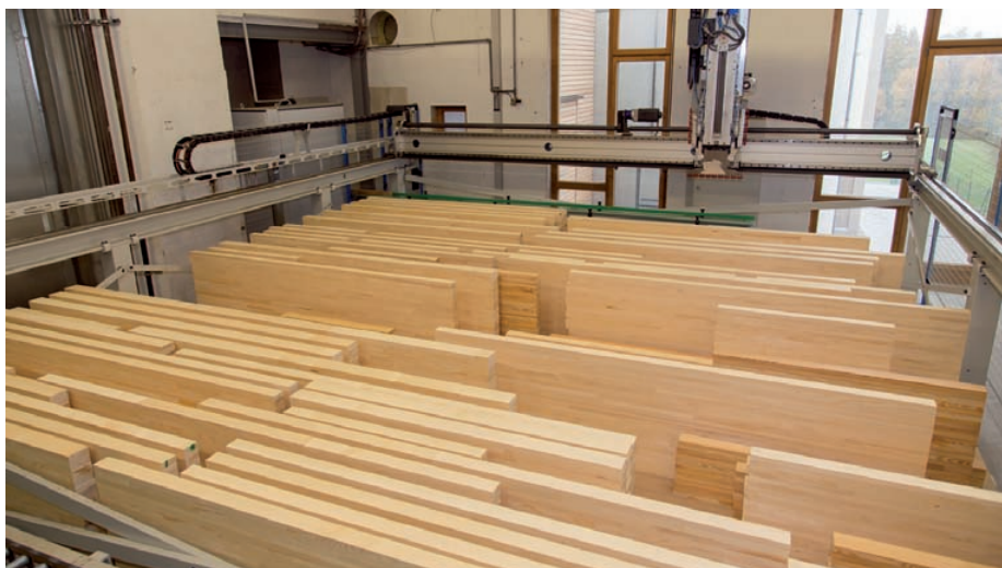
Ein Puffer, in dem bis zu 1.000 auf dem Vierseiter ausgehobelte Kanteln zwischengelagert werden, versorgt die Working Process.
