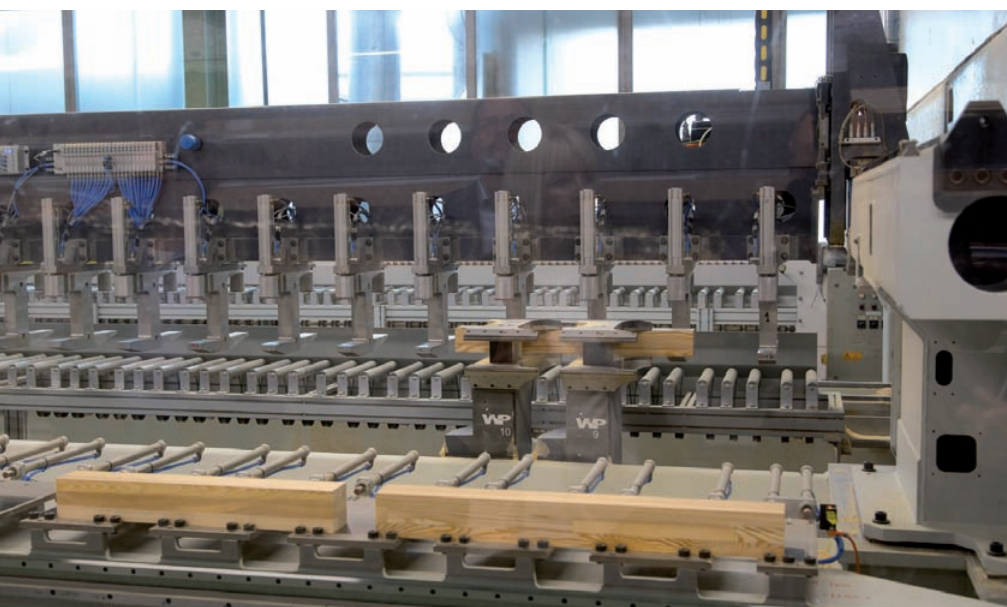
Während die Teile bearbeitet werden, wird schon die nächste Zangenladung bereit gelegt. Ein Optimierungsprogramm sorgt dafür, dass möglichst immer alle zehn Spannanzgen belegt werden und die maximale Bearbeitungslänge genutzt wird.
