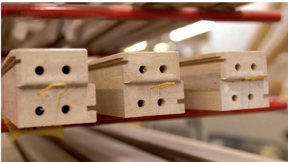
*Das Geheimnis hoher Produktivität: Schon seit 2008 setzt Rauh auf die konsequente Einzelteilfertigung. Diese gewährleistet, dass auch die Hirnholzflächen durch eine mehrstufige Beschichtung geschützt sind.*
